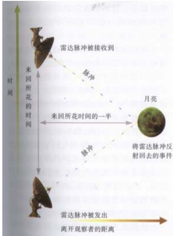
图 2.1 时间用垂直坐标测量，离开观察者的距离用水平坐标测量。观察者在空间和时间里的途径用左边的垂线表示。到事件去和从事件来的光线的途径用对角线表示。
